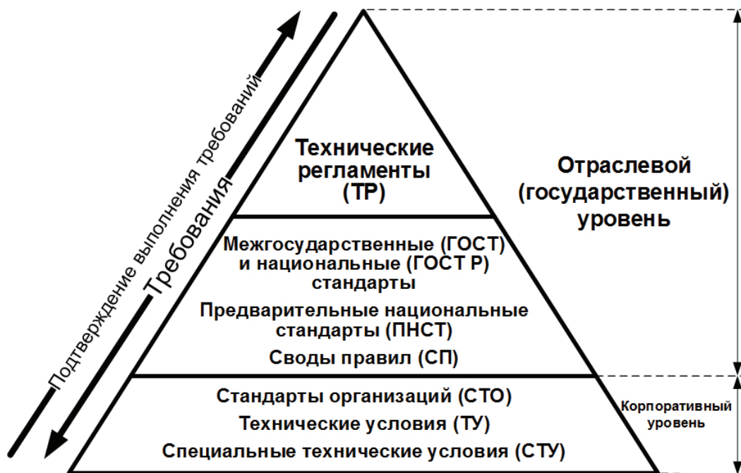
Рис. 2. Система нормативно-технического регулирования безопасности в России
