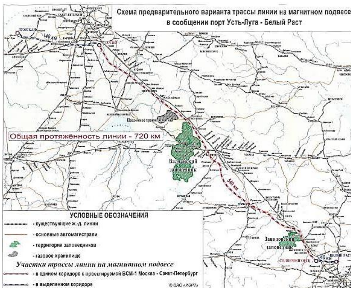
Рис. 3. Схема предполагаемой магнитолевитационной трассы
