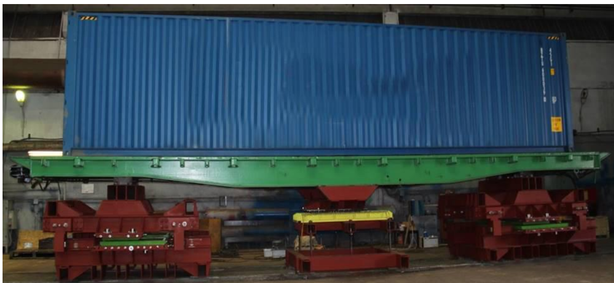
Рис. 2. Фото полномасштабного образца грузовой магнитолевитационной транспортной платформы
