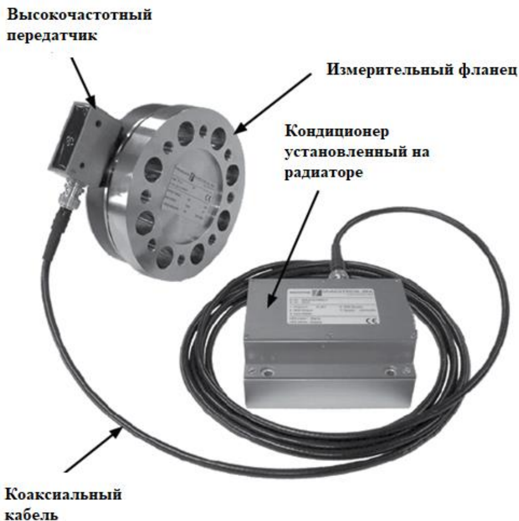
Рис. 1. Комплект датчика крутящего момента серии TF
