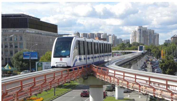
Рис. 1. Магнитнолевитационный транспорт на эстакаде
