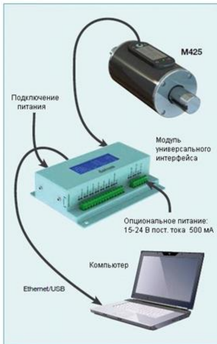
Рис. 2. Подключение модульного интерфейса к датчику крутящего момента М425
