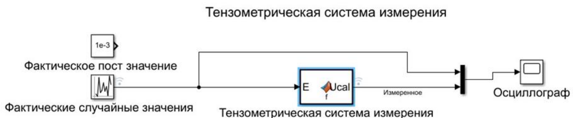
Рис. 2. Структура математической модели тензометрической системы измерения
