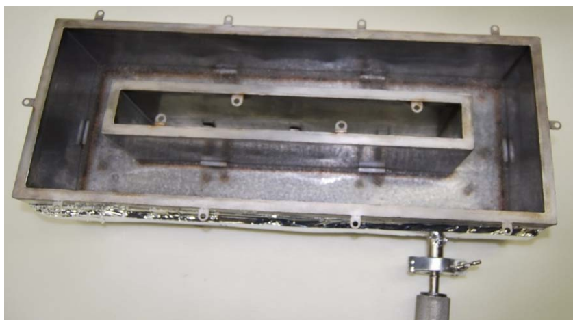
Рис. 12. «Холодные» испытания жидким азотом
