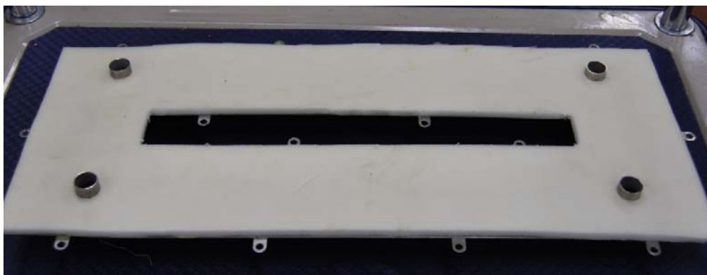
Рис. 10. Внешний вид изоляции на крышке криостата
