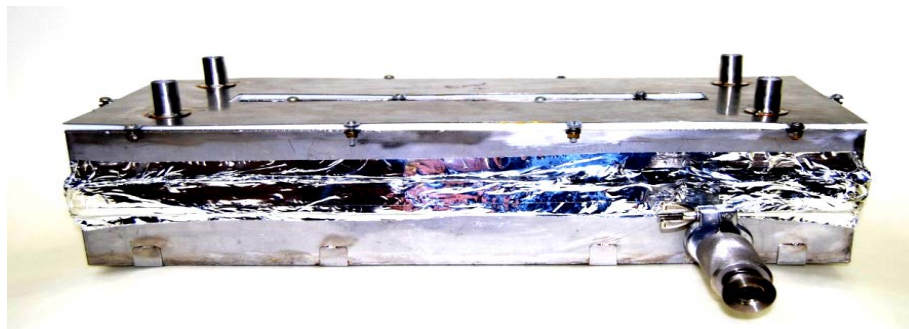
Рис. 7. Внешний вид азотного криостата
