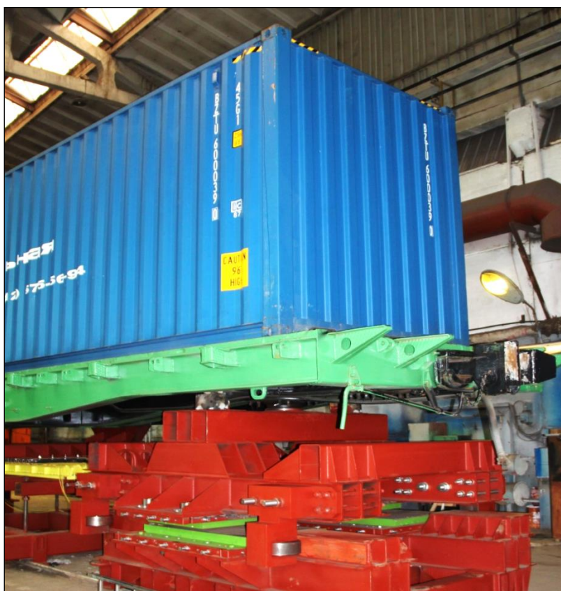
Рис. 1. Железнодорожная грузовая платформа модели 13-401, использованная в эксперименте на Александровском заводе в качестве шасси под контейнером
