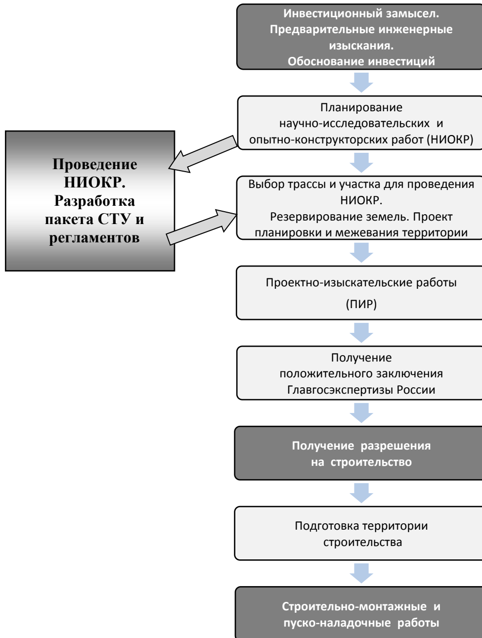
Рис. 3. Общая последовательность проектирования и строительства «пилотного» объекта, на котором можно было бы решить все экспериментальные задачи.
