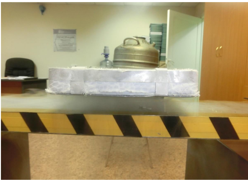
Рис.10. Демонстрация левитационного зазора
