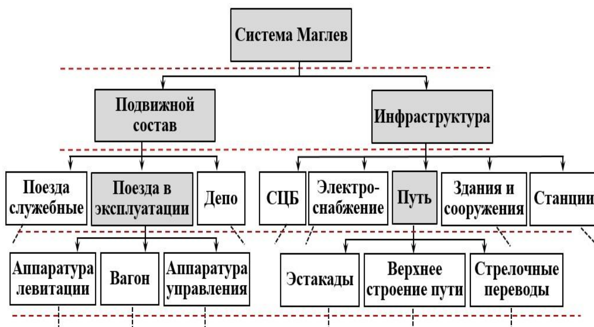
Рис. 3. Фрагмент функциональной модели магнитолевитационного транспорта
