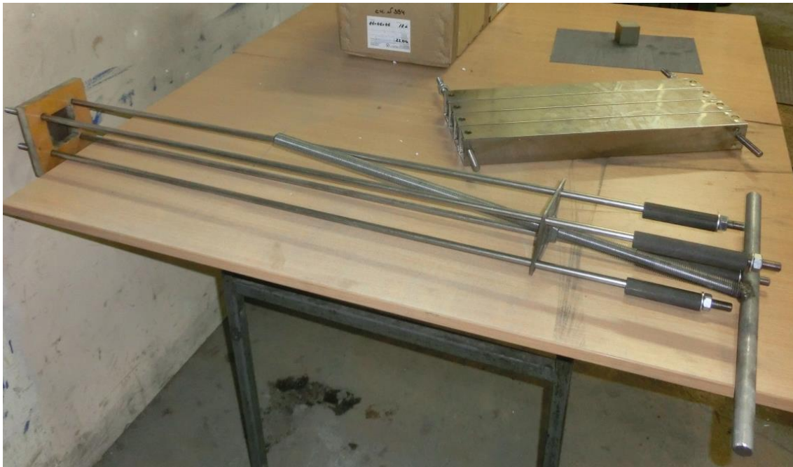
Рис.17. Устройство для помещения магнитов в элементарный блок
