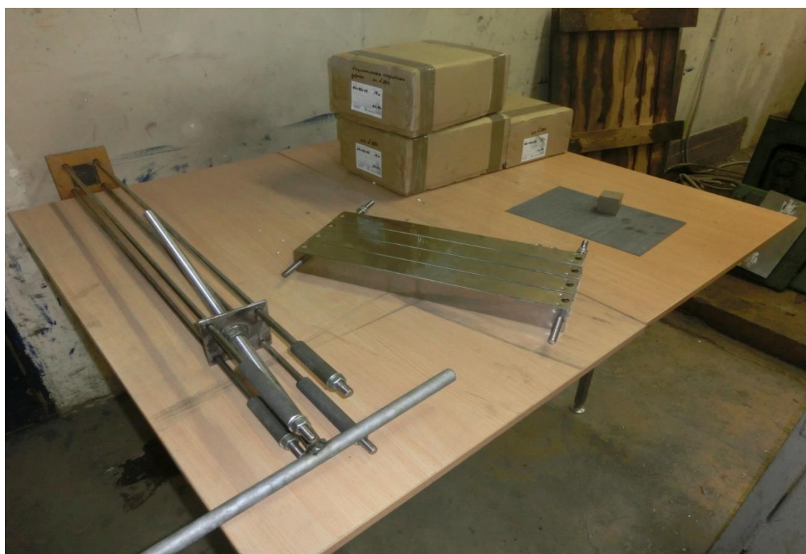
Рис.16. Устройство для помещения магнитов в элементарный блок
