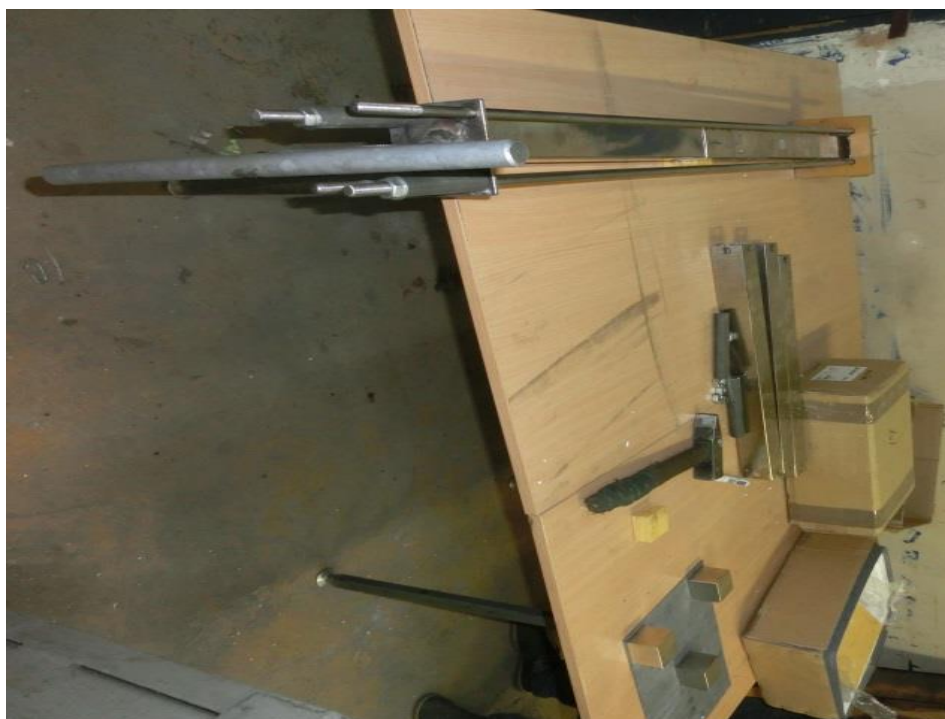
Рис.14. Устройство для установки магнитов в элементарный блок
