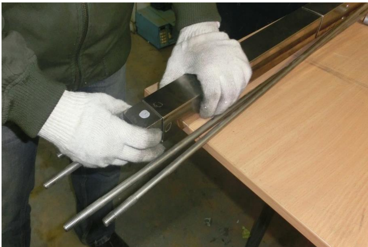
Рис.13. Установка магнита в элементарный блок
