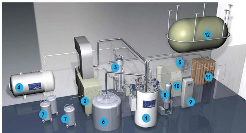
Рис. 2. Принципиальная схема получения жидкого гелия
