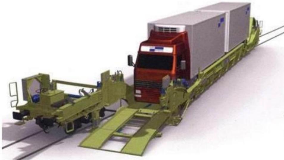
Рис. 8. Поворотная платформа системы «Flexiwaggon»
