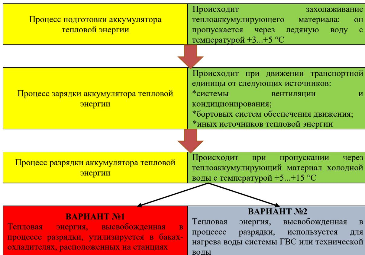
Рис. 3. Укрупненная схема процесса эксплуатации аккумулятора тепловой энергии
