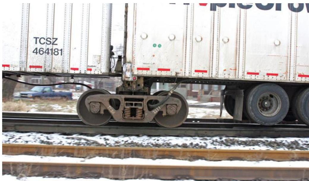
Рис. 3. Вагонная тележка системы «RoadRailer»
