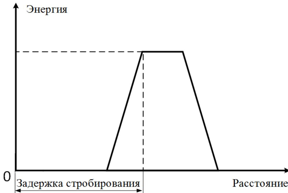
Рис. 2. Активная зона видения для прямоугольных импульсов подсвета и стробирования при  $\tau_L < \tau_g$
