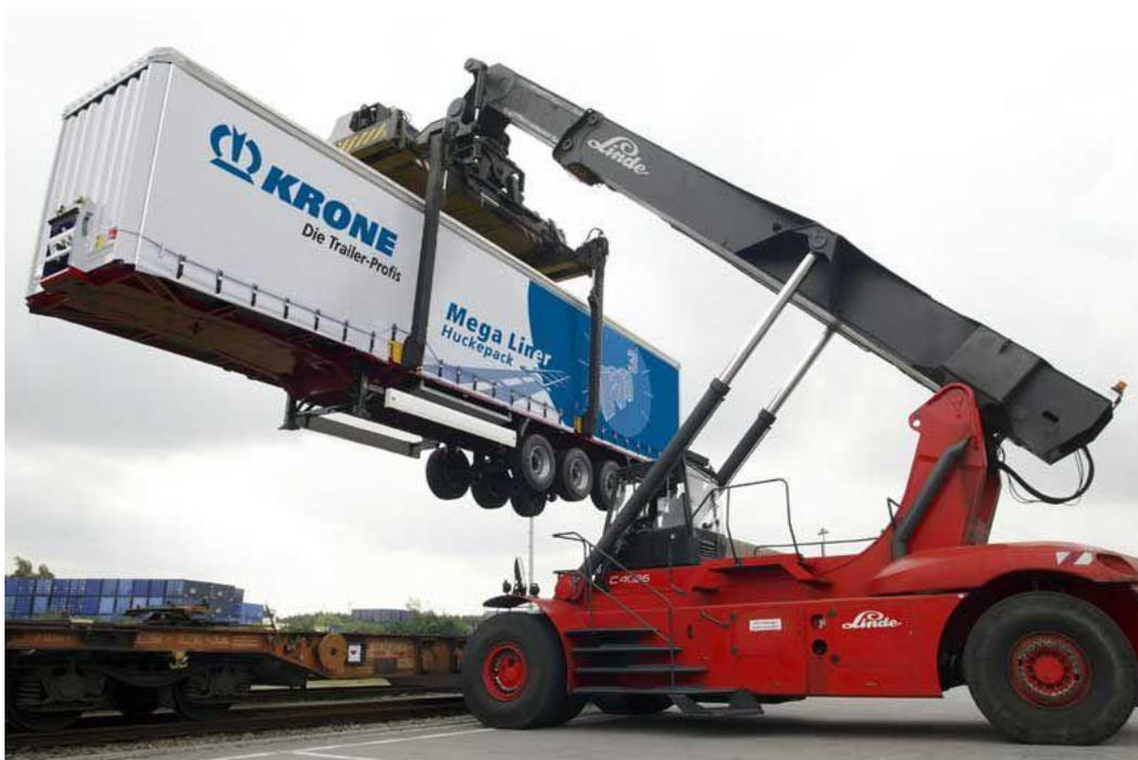
Рис. 1. Погрузка трейлера на платформу ричстакером
