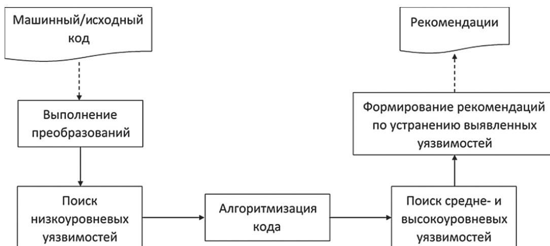
Рис. 2. Алгоритм создания безошибочного и устойчивого к воздействиям ПО
