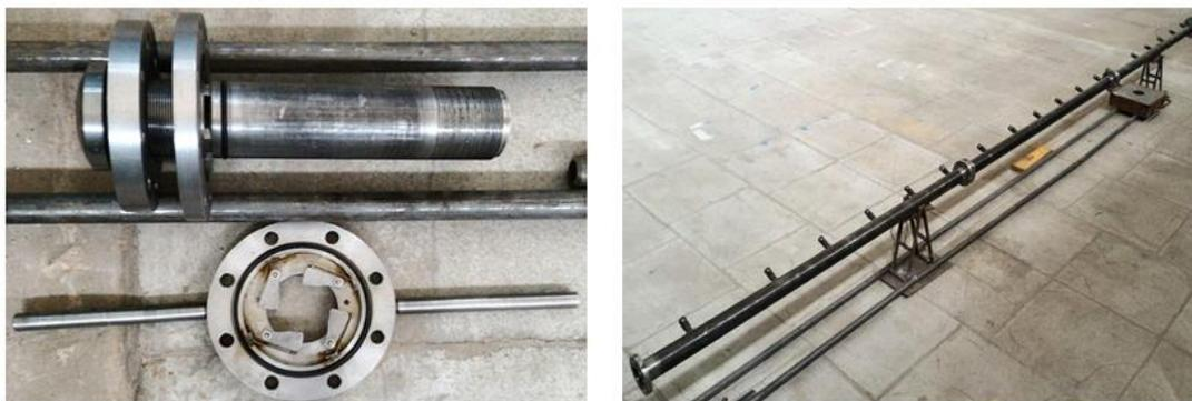
Рис. 16. Пусковое устройство и ствол на опорах
