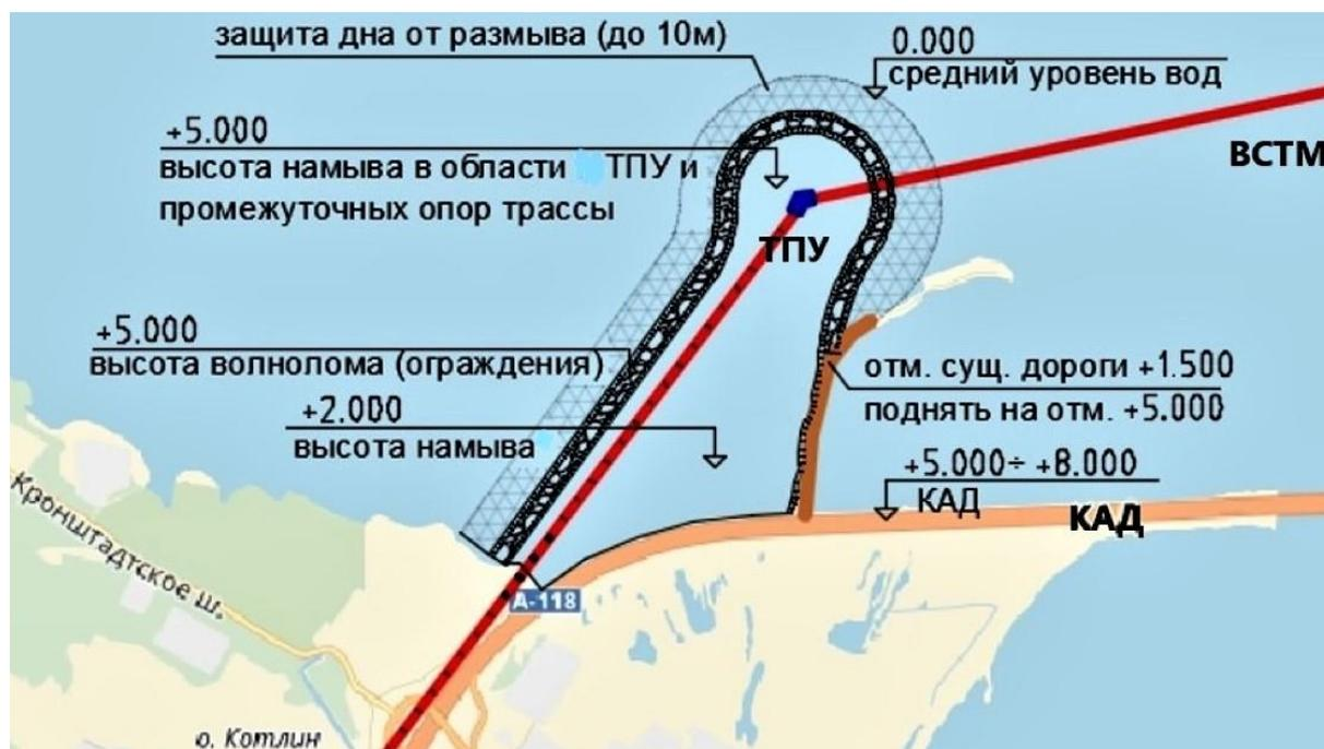
Рис. 2. Транспортно-пересадочный узел “Кронштадт” на намывном полуострове
