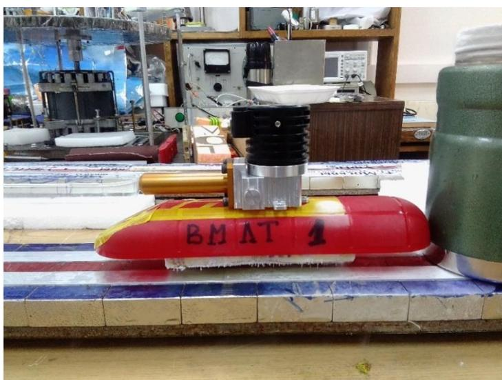
Рис. 21. Левитация массо-габаритного макета СМС на борту левитера над трассой из РЗМ
