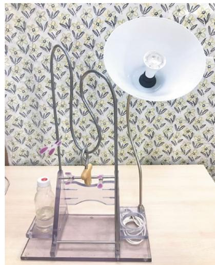
图 2. 评估修复结果和进行假体使用培训的测试站
