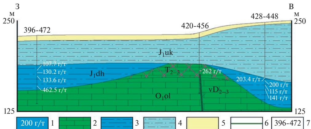
**Фиг. 8.** Широтный геологический профиль по линии скважин 396-472–420-456–428-448 участка с концентрациями скандия Накынского кимберлитового поля. Отношение вертикального и горизонтального масштабов 1 : 250; 1 – содержание скандия в г/т; 2 – известняки олондинской свиты; 3 – глины джартарской толщи; 4 – алевриты и алевропесчаники укугутской свиты; 5 – четвертичные отложения; 6 – дайка девонских долеритов; 7 – номер скважины. Штриховкой показана захороненная кора выветривания.
