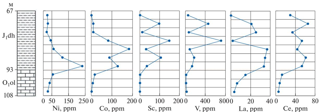
**Фиг. 6.** Распределение Ni, Co, Sc, V, La, Se по скважине 400–347 (результаты РФА по пробам, отобранными геологами ВГРЭ), вскрывающей разрез коры выветривания в центральной части рудопоявления скандия в Накынской поле. O<sub>1ol</sub> – известняки олдондинской свиты нижнего ордовика, J<sub>1dh</sub> – преимущественно глинистые отложения дяктарской толщи нижней юры.
