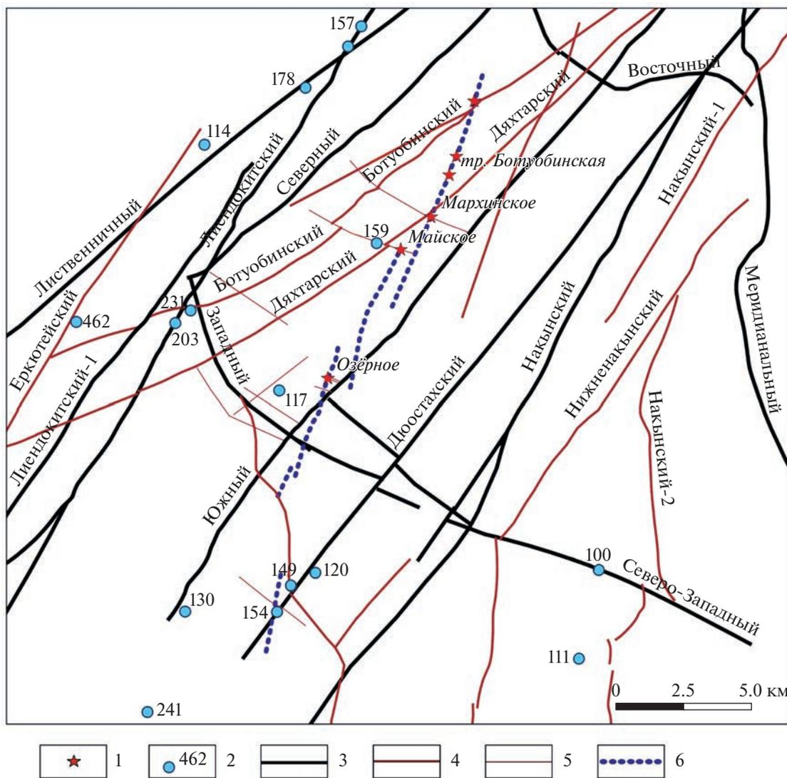
**Фиг. 3.** Положение концентрационных аномалий скандия в разломных структурах Накынского поля. 1 – известные кимберлитовые тела; 2 – разрезы джартарской толщи, в которых содержание Sc выше 100 г/т; 3–6 – осевые зоны разрывных нарушений, выделенные по данным магниторазведки, сейсморазведки и картирования микротектонических нарушений: 3 – высокого порядка, 4 – среднего порядка, 5 – низкого порядка, 6 – сегменты рудоконтролирующего Диагонального разлома.
