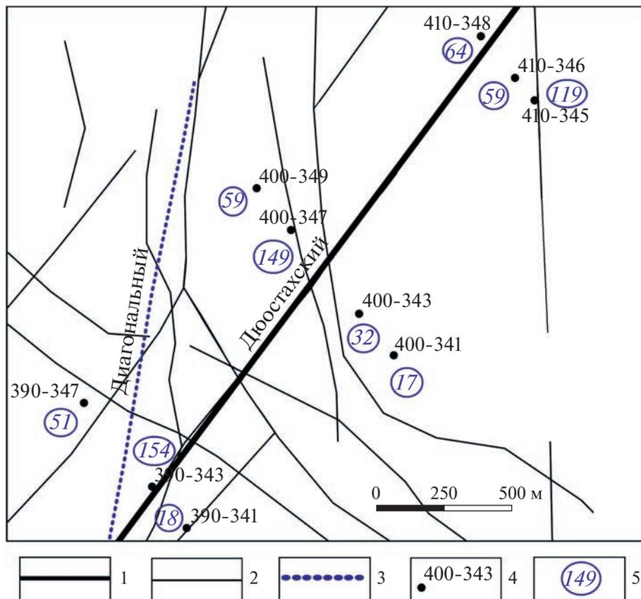
**Фиг. 5.** Рудопроявление скандия в глинах дяктарской толщи в узле пересечения Западного, Дюостахского и Диагонального разломов Накынского поля с условным центром у скв. 400-347. 1 – осевая зона Дюостахского разлома, 2 – разломы второго порядка, 3 – фрагмент Диагонального кимберлитоконтролирующего разлома, 4 – номер поисковой скважины, 5 – содержания Sc в г/т.
