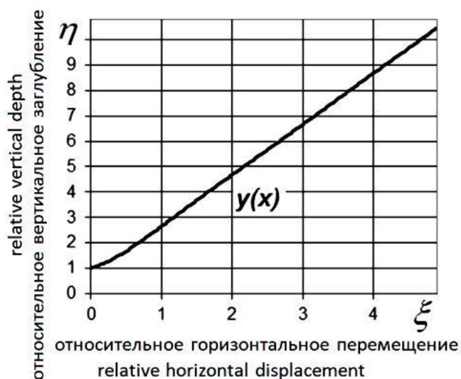
Рис. 5. Траектория движения штампа y(x) для разных грунтов и размеров штампа.
