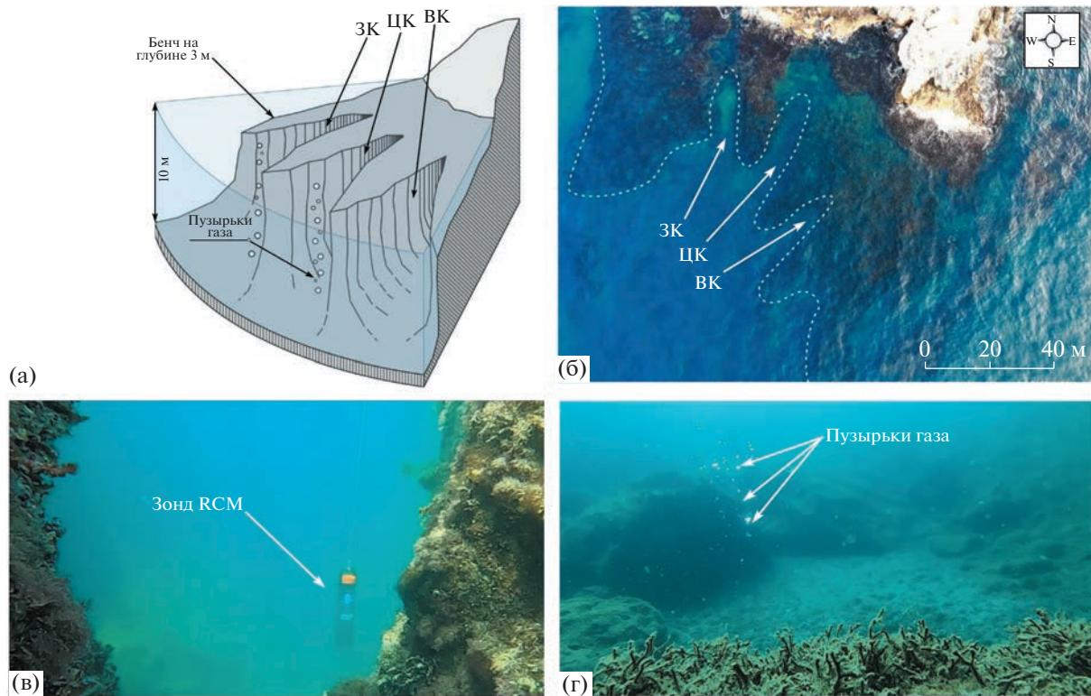
**Рис. 1.** Схема подводного рельефа дна (а) и фотография оконечности мыса Феофан с квадрокоптера (б), стрелками отмечены западный (ЗК), центральный (ЦК) и восточный каньоны (ВК) пунктирной линией отмечены их границы; подводные фотографии зонда RCM 9 LW AANDERAA во время зондирования (в) и пузырьковых газовыделений в западном каньоне (г).
