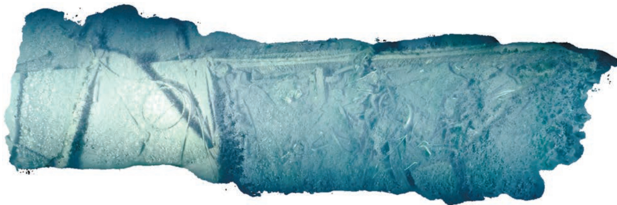
Рис. 10. Трехмерное изображение фрагмента палубы танкера ТНТ-15, затопленного в Новоземельской впадине, построенное по материалам видеозаписей, полученных с помощью БНПА “Видеомодуль” в 72-м рейсе НИС “Академик Мстислав Келдыш”, в 2018 г.
