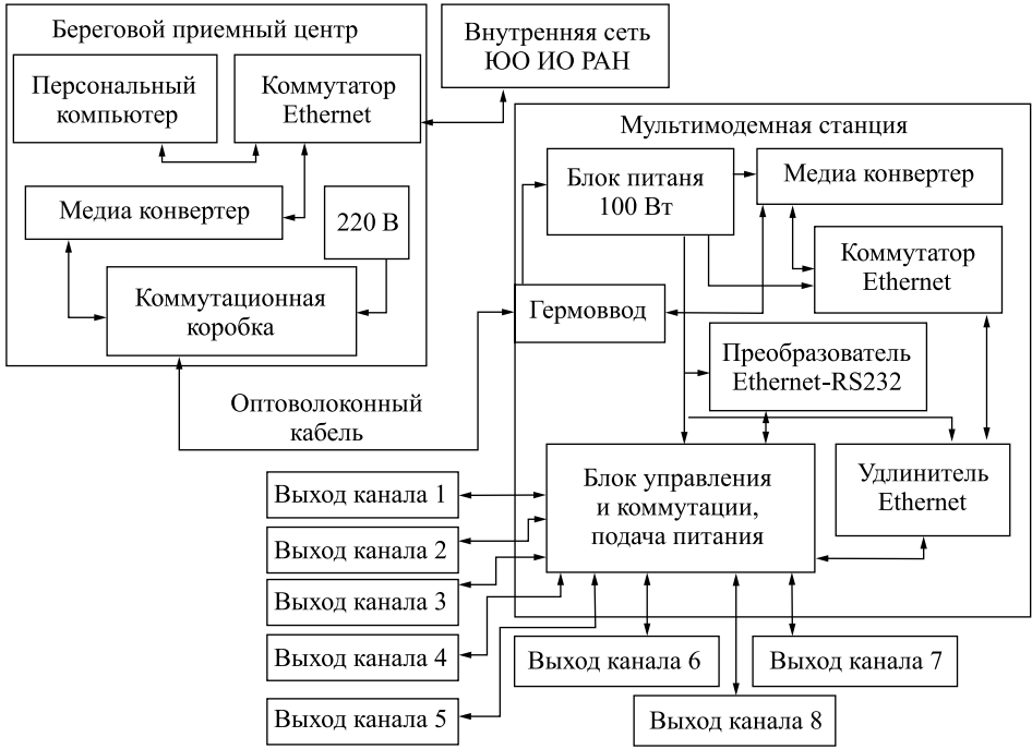
Рис. 4. Структурная схема донной мультимодемной станции.
