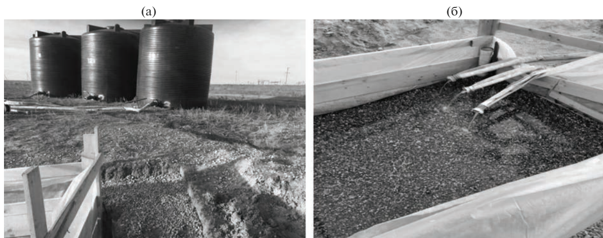
Рис. 5. Подача воды из заполненных емкостей ( 30 \text{ м}^3 ) в инфильтрационный бассейн с отрегулированным расходом (для автоматического заполнения в течение суток).
