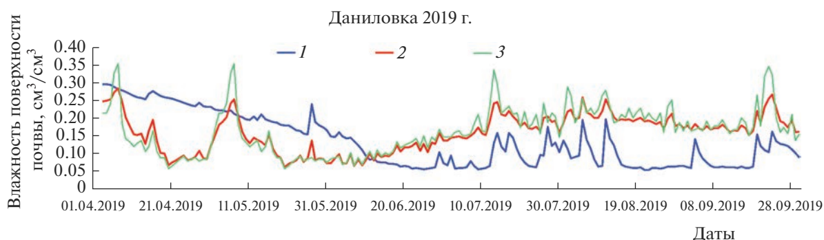
Рис. 1. Влажность поверхности почвы, рассчитанная с помощью модели по данным наземных измерений (1) и при использовании оценок испарения, полученных с привлечением данных ASCAT/MetOp (2), определенная непосредственно по измерениям ASCAT (3). Агрометеорологическая ст. Даниловка (Волгоградская обл.). Сезон вегетации 2019 г.
