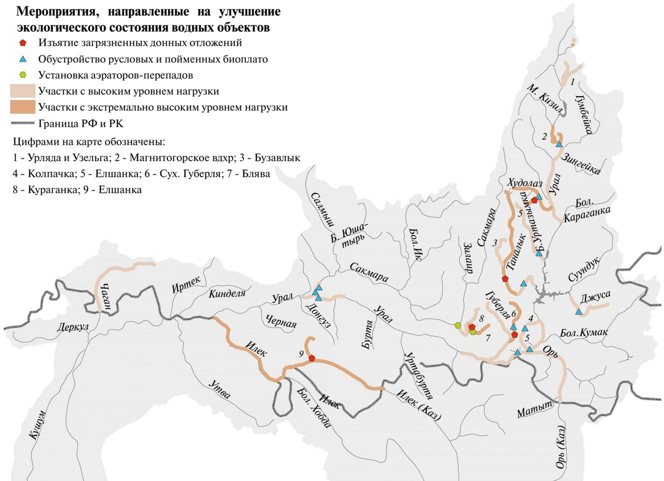
**Рис. 9.** Пилотные участки водных объектов для проведения мероприятий по улучшению их экологического состояния, осуществляемых в акватории водных объектов.
