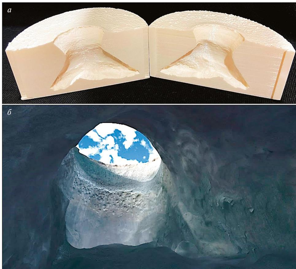
**Рис. 6.** Физическая 3D-модель (а) и изображение в виртуальной реальности со дна (б) подземной полости с кратером выброса газа Бованенковского объекта С17
