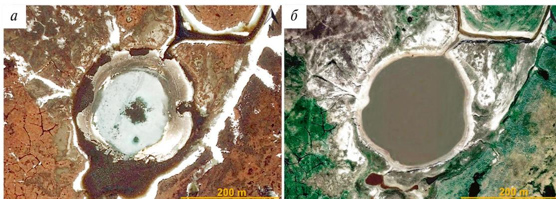
**Рис. 10.** Космоснимки WorldView-2 14 июня (а) и 21 июля (б) 2014 г. техногенного кратера вокруг устья скважины Бованенковская-118
